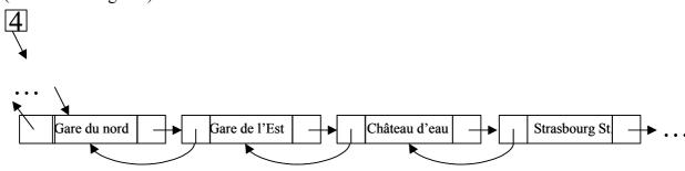
Chaque cellule contient un pointeur sur l'élément précédent, le nom de la station et un pointeur sur l'élément suivant. Cette représentation permet de rechercher :
